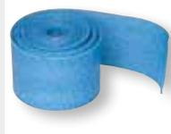
Bande en mousse de polyéthylène extrudée destinée à désolidariser les chapes flottantes, mortier de scellement, chapes sèches des parois verticales, des pieds d'hubriserie, seuils et de toute émergence.
